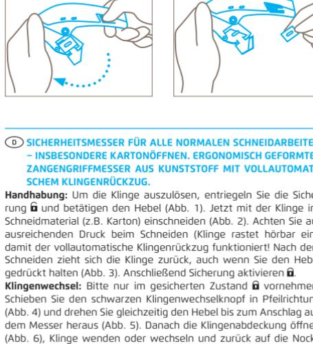
**D SICHERHEITSMESSER FÜR ALLE NORMALEN SCHNEIDARBEITEN – INSBESONDERE KARTONÖFFNEN. ERGONOMISCH GEFORMTES ZANGENGRIFFMESSER AUS KUNSTSTOFF MIT VOLLAUTOMATISCHEM KLINGENRÜCKZUG.**
