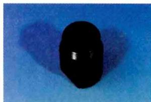
Bei einer Montage von Edelstahlrohren ist die Vormontage ausschließlich im gehärteten VOMO vorzunehmen. Eine direkte Montage im Edelstahlstutzen muß vermieden werden! Die Konen der VOMOS unterliegen einem Verschleiß und müssen deshalb in regelmäßigen Zeitabständen mit einer Konuslehre auf Lehrenhaltigkeit überprüft werden. Um Fehlmontagen von vornherein auszuschließen, sind abgenutzte VOMOS gegen neue auszutauschen.
