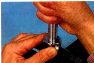
Die Einheit Rohr, Schneidring und Überwurfmutter in den VOMO schieben. Die Überwurfmutter bis zur fühlbaren Anlage von Hand auf den VOMO aufschrauben.
