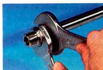
Nach Gutbefund das vormontierte Rohr in den Verschraubungsstutzen einsetzen. Die Überwurfmutter ca. 1/4 - 1/2 Umdrehung über den spürbaren Kraftanstieg anziehen. Der Stutzen muß mit einem Schlüssel gehalten werden.
