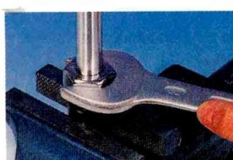
Mit einem Schlüssel ca. 1 - 1 1/2 Umdrehungen anziehen (je nach Größe unterschiedlich). Hierbei lässt sich das Rohr bis ca. 1/2 Umdrehung radial verdrehen, danach sollte es sich nicht mitdrehen.
