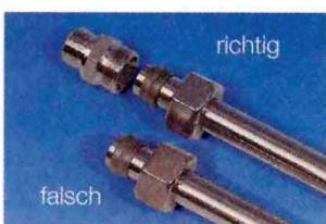
Überwurfmutter und Schneidring über das Rohrende schieben.
