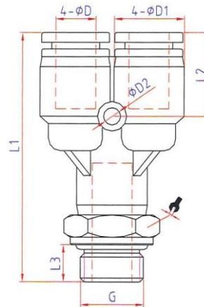
**Mehrfachverteiler mit Außengewinde**, 4-fach, drehbar, Außengewinde zylindrisch mit O-Ring (NBR)
