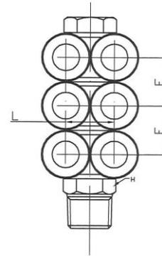
**L-Mehrfachverteiler mit Außensechskant, 4-**
