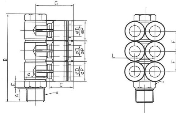
**L-Mehrfachverteiler mit Außensechskant, 6-fach, drehbar, Außengewinde konisch mit Gewindebeschichtung**
