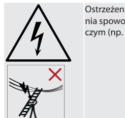
Ostrzeżenie, zagrożenie elektryczne. Określić wszystkie zagrożenia spowodowane przez sprzęt elektryczny w obszarze roboczym (np. napowietrzne linie wysokiego napięcia).
