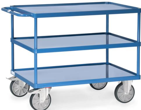
Stahlrohr und Profilstahl geschweißt, pulverbeschichtet RAL 5007. 3 Stahlblechwannen mit 10 mm hohem Rand, öldicht verschweißt, pulverbeschichtet RAL 5007. 2 Lenk- und 2 Bockrollen, TPE-Bereifung, Nabens mit Rillenkugellager. Feststeller an den Lenkrollen. Tragkraft obere und mittlere Ladefläche 200 kg.
