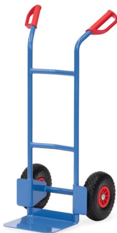
Handliche Stapelkarre mit Stahlblechschaufel, stabile Schweißkonstruktion, pulverbeschichtet blau RAL 5007. fetra Sicherheitsgriffe. Stahlblechschaufel anschraubar und dadurch austauschbar. Räder mit pannensicherer PU-Bereifung auf Kunststoff-Felgen, Nabenhügel oben und Querstreben durchgebogen. Für den sicheren Transport von runden Gütern, wie Rollen, Kannen, Eimern usw. Zerlegte Anlieferung.
