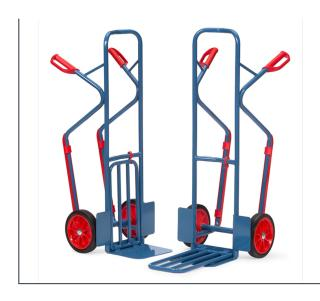
Handlich, mit großer Stahlrohr-Klappschaufel 500 x 250 mm. Stabile Schweißkonstruktion, pulverbeschichtet, blau RAL 5007. Sicherheitsgriffe. Räder mit Vollgummibereifung auf Kunststoff-Felgen. Naben mit Rollenlager. Bügel oben und Querstreben durchgebogen. Für den sicheren Transport von runden Gütern, wie Rollen, Kannen, Eimern usw. Zerlegte Anlieferung.
