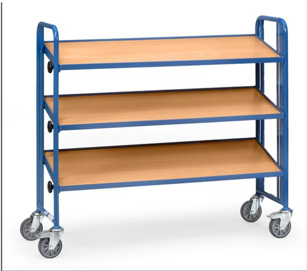
Baukasten-System: Stahlrohr- und Profilstahlgeweißt, pulverbeschichtet blau RAL 5007, Schraubkonstruktion. 3 variabel einschraubbare Etagen, Stahlrahmen mit eingelegter Holzwerkstoffplatte, Oberfläche Buchendekor, Rand 12 mm hoch. Einschraubraster 100 mm, Neigung stufenlos einstellbar von 0° bis 35°, sichere Arretierung mittels Griffschrauben. Deutsches Patent: 10 2005 062 391. Tragkraft pro Ladefläche 60 kg. 4 Lenkrollen, TPE-Bereifung, Naben mit Rillenkugellager. 2 Stück mit Feststeller.
