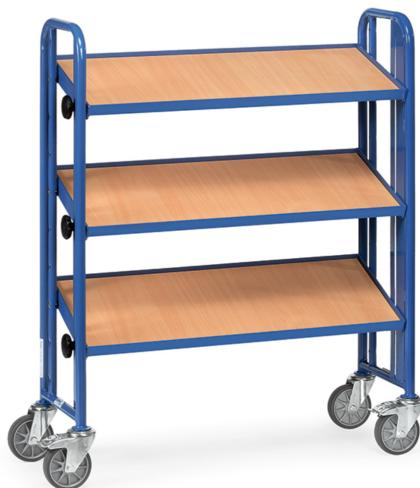
Baukasten-System: Stahlrohr- und Profilstahlgeschweißt, pulverbeschichtet blau RAL 5007, Schraubkonstruktion. 3 variabel einschraubbare Etagen, Stahlrahmen mit eingelegter Holzwerkstoffplatte, Oberfläche Buchendekor, Rand 12 mm hoch. Einschraubraster 100 mm, Neigung stufenlos einstellbar von 0° bis 35°, sichere Arretierung mittels Griffsschrauben. Deutsches Patent: 10 2005 062 391. Tragkraft pro Ladefläche 60 kg. 4 Lenkrollen, TPE-Bereifung, Nabens mit Rillenkugellager. 2 Stück mit Feststeller.
