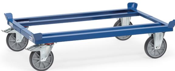
Für Flachpaletten und Gitterboxen. Robuste Winkelstahl-Schweißkonstruktion, mit 4 Fangecken, pulverbeschichtet, blau RAL 5007. 2 Lenk- und 2 Bockrollen, TPE-Bereifung, Nabens mit Rillenkugellager, Feststeller an den Lenkrollen. Standard-Beräderung für mittlere Belastungen. Geräuscharmer Lauf.
