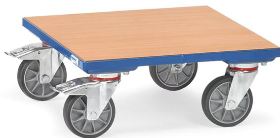
Aus Winkelstahl, geschweißt, pulverbeschichtet blau RAL 5007. Ladefläche aus Holzwerkstoffplatte, Oberfläche Buchendekor. 4 Lenkrollen, TPE-Bereifung, Naben mit Rillenkugellager. 2 Stück mit Feststeller.
